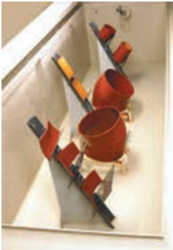
Salzspühnebeltest 1500 h (Materialprüfungsamt Nordrhein-Westfalen in Dortmund)
